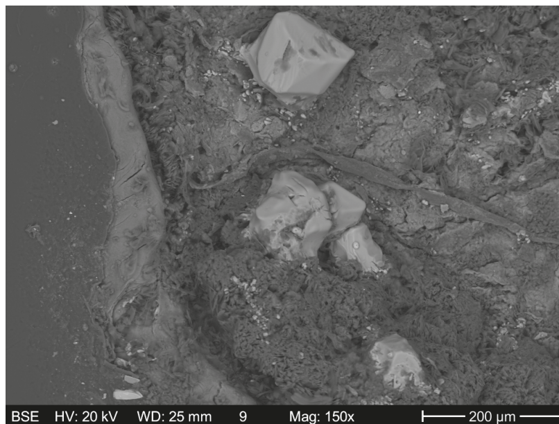
Figura 16 – Imagem de elétrons retroespalhados em microscópio eletrônico de varredura de sveíta (cinza escuro) com nitro (cinza claro).
