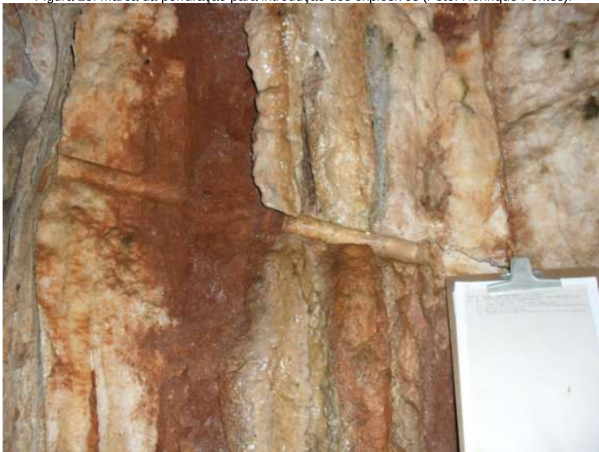
Figura 25: Marca da perfuração para introdução dos explosivos (Foto: Henrique Pontes).
